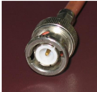
Figura 4. Conector BNC macho de 50 Ω
