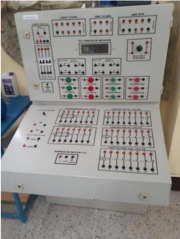
Figura 4. Laboratorio de automatización industrial con PLC y módulos de ampliación.
