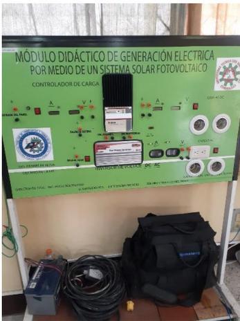
Figura 7. Módulo didáctico de generación eléctrica por medio de un sistema solar fotovoltaico.
