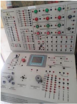
Figura 1. Laboratorio de automatización industrial con HMI.
