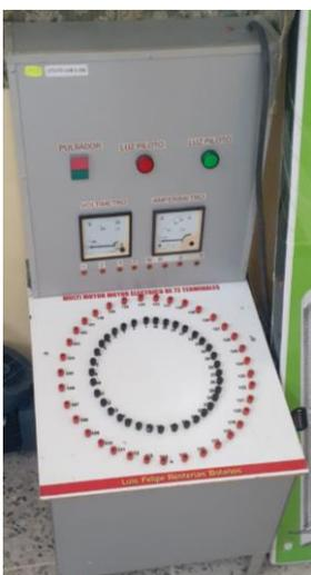
Figura 3. Laboratorio de motor eléctrico de 72 terminales.
