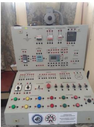
Figura 2. Laboratorio de automatización industrial con PLC LOGO
