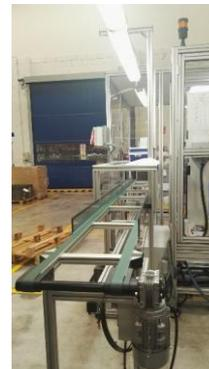
**Imagen 3.3.1.2.** Cinta transportadora con rejillas.
