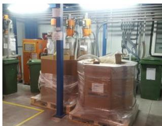
Para el funcionamiento de la máquina, se utiliza el aire comprimido que dispone la misma, el cual se destensa a presión atmosférica. Así se genera aire seco con un punto de rocío muy bajo, el cual «inertiza» y mantiene seco el granulado. Esto aumenta la seguridad en la producción y, debido al volumen reducido de aire comprimido, se ahorra energía porque la materia prima no se tiene que volver a secar por regla general.
