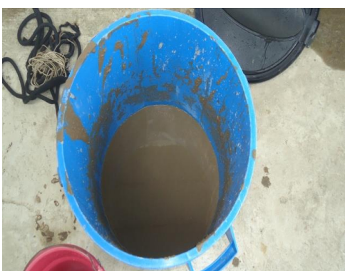
Figura 19. Homogenización de lodos.
