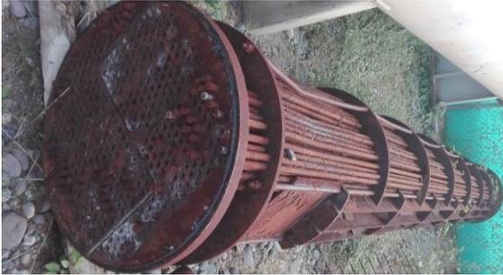
**Figura 2.** Tubos de un intercambiador de calor- corrosión generalizada (Refinería de Esmeraldas, 2017)
