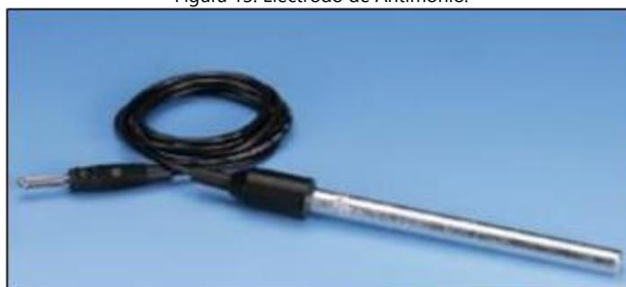
A continuación, presentamos como se debe realizar de medición del pH del suelo en el área de las estructuras metálicas enterradas, para complementar el estudio de SPC como mostramos en la figura 2, el positivo del voltímetro lo conectamos en el electrodo de referencia cobre/sulfato de cobre y el negativo lo conectamos el electrodo de antimonio así nos dará el dato que se requiere del pH del suelo, (Suque, 2008).
