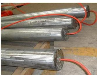
Ya conocido el ánodo que se empleará en nuestro SPC por corriente impresa, procedemos a determinar la cantidad de ánodos que se emplearán, para lo cual utilizamos la capacidad de drenaje de corriente de los ánodos que se muestra en la tabla 5, de característica técnica del ánodo (Suque, 2008).
